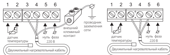
Схема подключения к 3-х проводной электрической сети
