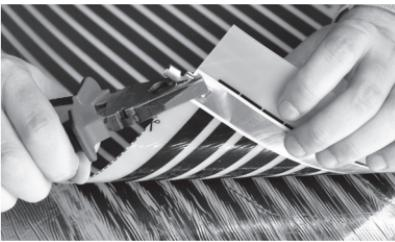
Рис. 6. Крепление контактного зажима к термопленке
