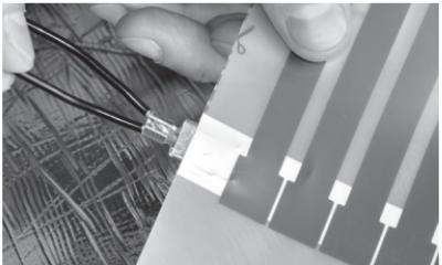
Рис. 11. Соединение монтажных проводов с контактным зажимом
