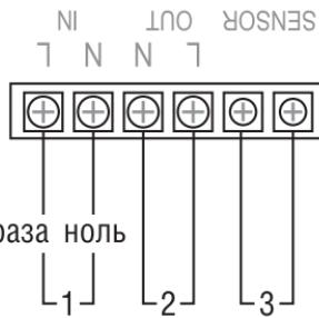
Рис. 15. Пример подключения соединительных проводов к терморегулятору
