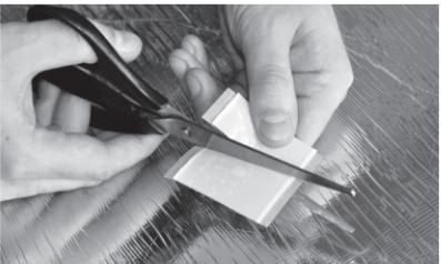
Рис. 7. Разрезание битумной изоляции на 2 части
