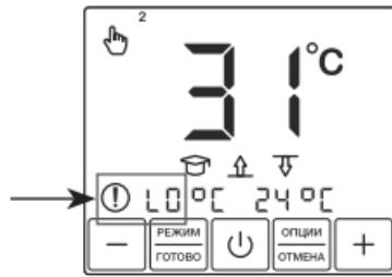
Рис. 17. Обрыв датчика обогрева
