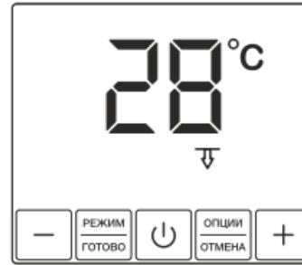
Рис. 12. Установка максимальной температуры воздуха
