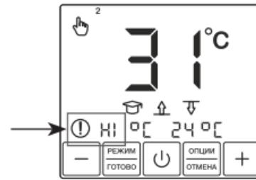
Рис. 18. Замыкание датчика обогрева
